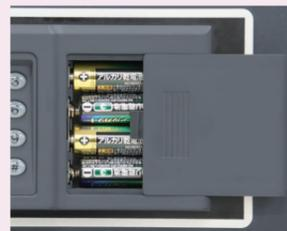
電源は、単3形アルカリ乾電池4本。扉表の操作部に格納されていますので、万一の電池切れでも簡単に交換し、すぐに使用できます。
