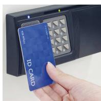
ご利用中の IC カードを登録し、解錠できます。操作履歴が記録されます。扉を閉めると自動的に施錠されます。(オートロック機構)
